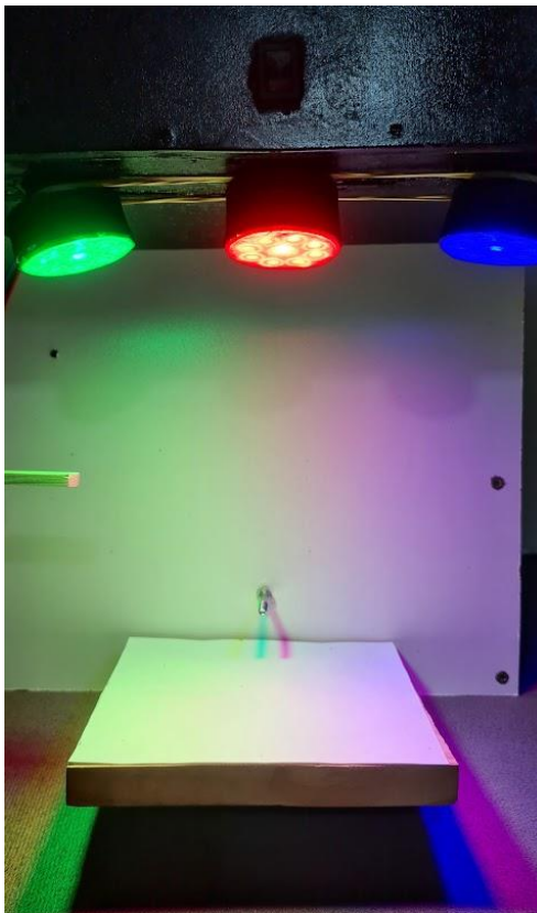
Figura 16: Caixa de cores demonstrando a formação da cor branca no papel sulfite e das cores secundárias representadas pelas “sombras” do parafuso.
