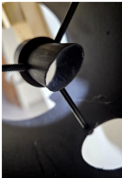
Figura 3: Espelho secundário fixado ao tudo de PVC Soldável de 20 mm.
